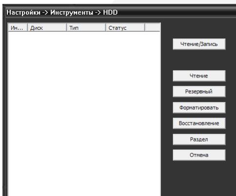
При подключении к камере с SD-картой будет строка с указанием типа, статуса карты. При подключении к регистратору будет произведена идентификация жёсткого диска используемого в регистраторе.
