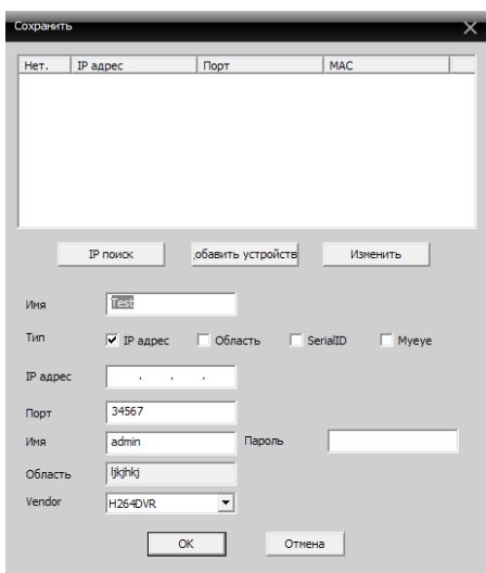
Имеется возможность автотоиска подключенных устройств
