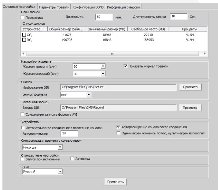
Перезапись – при включении данной функции, запись будет производиться циклически после заполнения дискового пространства.
