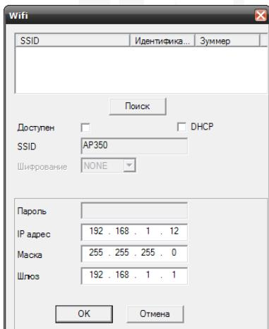
Для поиска доступных беспроводных сетей, следует установить галку в пункте «Доступен» и нажать кнопку «Поиск».
